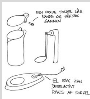
Figur 6.2 Skitse over et alternativt og mere miljøvenligt design af el-kedlen.
