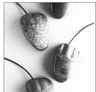
Eksempel på dekoration af dobbeltkrumme plastikoverflader
