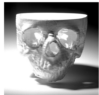
Kranium fremstillet med SLA
